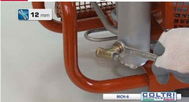
Avvitare il raccordo sul separatore di condensa
