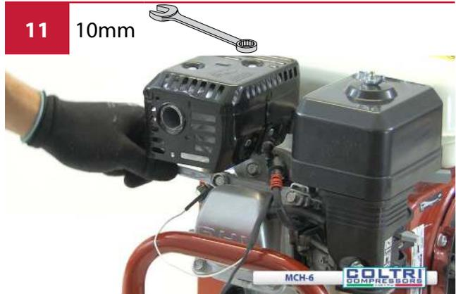
Avvitare la vite di fissaggio del carter motore
