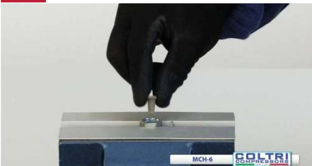
Inserire, nel connettore filtro, il filtro sinterizzato
