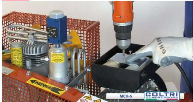
Togliere le 2 viti di fissaggio del fermo condensatori
