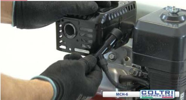
Togliere la calotta elettrica della candela del motore
