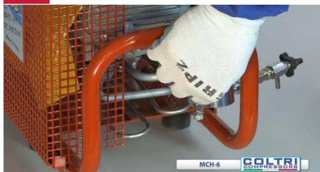
Avvitare il raccordo a L sulla valvola solenoide alta pressione
