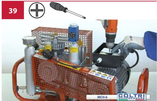
Mettere le 2 viti di fissaggio del fermo condensatori
