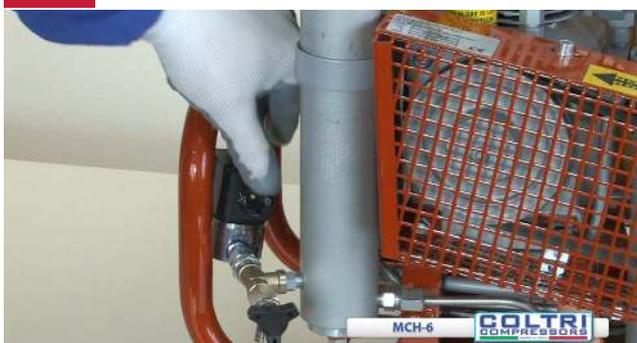
Mettere la bobina nel fusto valvola solenoide alta pressione
