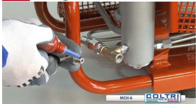
Applicare Loktite 243 sul filetto del rubinetto scarico condensa
