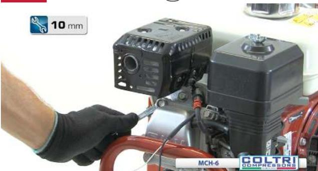
Allentare la vite di fissaggio del carter motore
