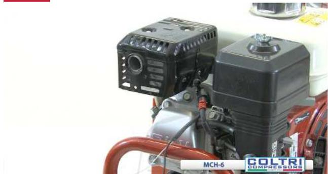
Mettere la calotta elettrica sulla candela del motore
