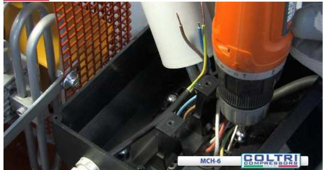
Togliere una delle viti di fissaggio della scatola elettrica
