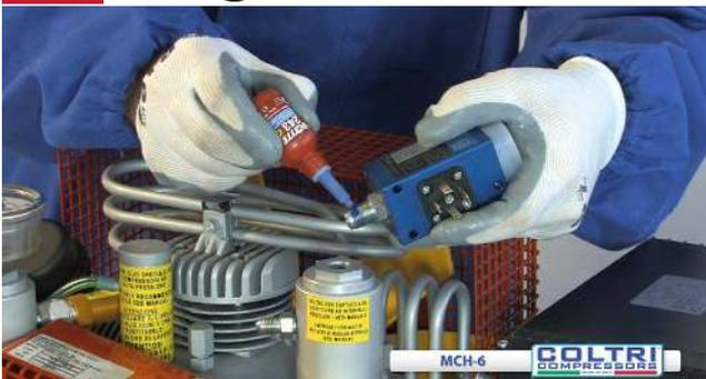
Applicare Loktite 243 sul filetto del pressostato
