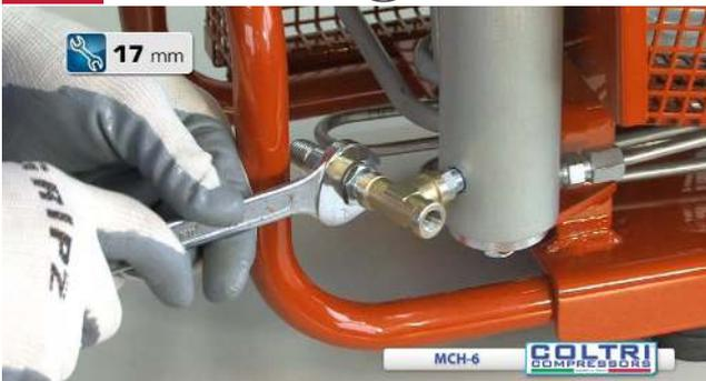
Avvitare il connettore filtro sul raccordo a T
