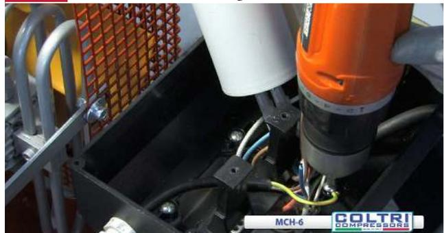
Mettere la vite di fissaggio della scatola elettrica
