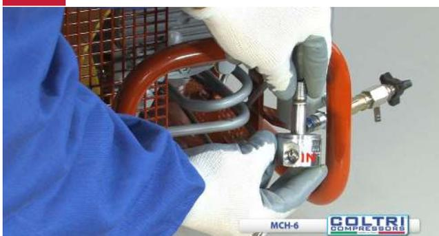
Posizionare l'entrata IN della valvola solenoide alta pressione sul connettore filtro
