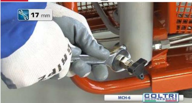
Avvitare il rubinetto scarico condensa sul raccordo a T
