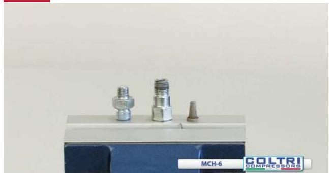
Assemblare il connettore filtro sinterizzato
